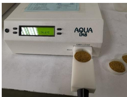
ภาพ 3.12 การตรวจวัดการวิเคราะห์หาปริมาณน้ำอิสระของดอกคาโมไมล์อบแห้งด้วยเครื่อง AQUA lab
