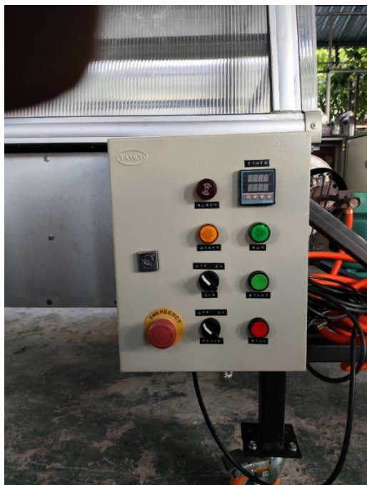
ภาพ ก.1 (ก) เชื้อทำความสะอาดแผ่นโพลีคาร์บอเนต (ข) ประกอบสายไฟเพื่อป้อนหลอดความร้อนเสริม (ค) ตัวควบคุมระบบความร้อนเสริม (ง) ติดตั้งพัดลมระบายความร้อน
