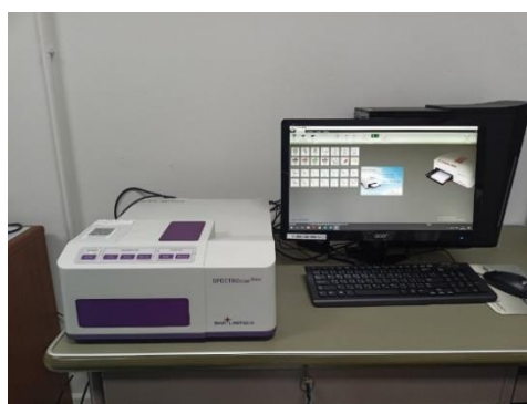
ภาพที่ 3.16 วัดสารประกอบฟีนอลิกรวมด้วยเครื่อง Microplate Reader
