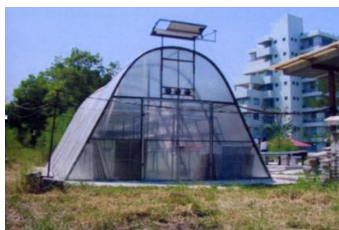
ภาพ 2.6 ตู้อบแห้งแบบโซล่ากรีนเฮาส์ Greenhouse dryer
