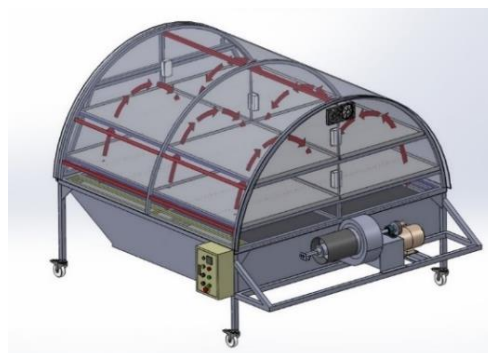
ภาพ 3.7 ลักษณะการไหลเวียนลมร้อนภายในโรงอบพลังงานแสงอาทิตย์แบบเรือนกระจกระบบความร้อนร่วม
