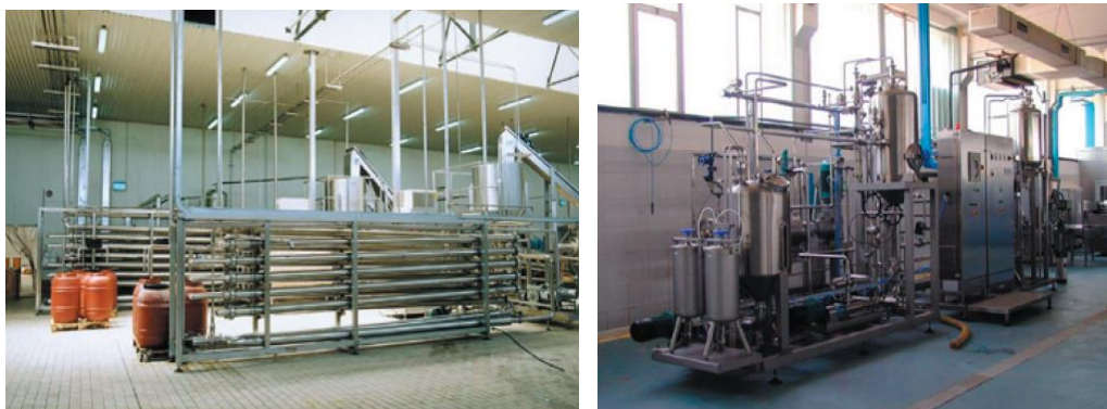
ภาพ 2.9 ระบบการแปรรูปด้วยวิธีการให้ความร้อนแบบปลอดเชื้อระบบต่อเนื่อง ที่มา : Ramaswamy และคณะ, (2005)
