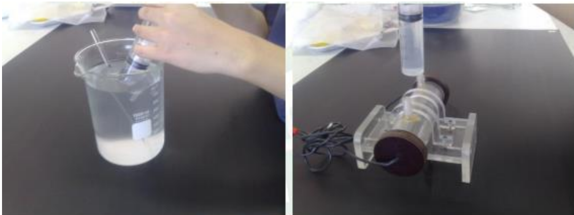
ภาพ 4.24 เมื่อละลายเกลือจนหมดแล้วดูดสารละลายเกลือ ลงในโอห์มมิคเซลล์ที่ได้เตรียมเอาไว้ เพื่อทำการทดลองต่อไป ที่มา: สิริรัตน์และ อิศราพงศ์ (2554)
