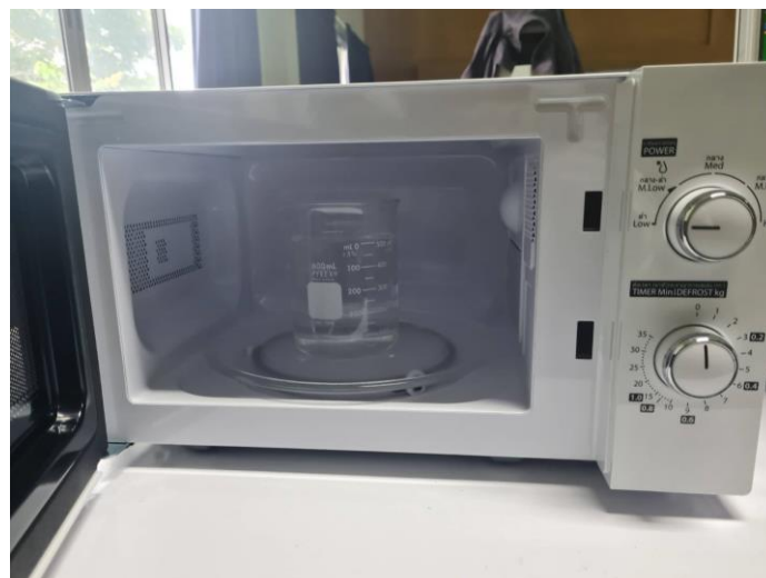
ภาพ 3.2 การวัดค่ากำลังงานไมโครเวฟด้วยสารมาตรฐาน
