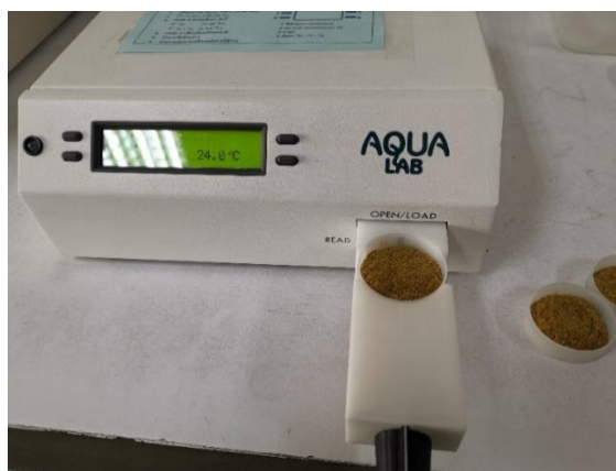
ภาพ 3.11 การตรวจวัดการวิเคราะห์หาปริมาณน้ำอิสระของดอกเก็กฮวยอบแห้งด้วยเครื่อง AQUA lab
