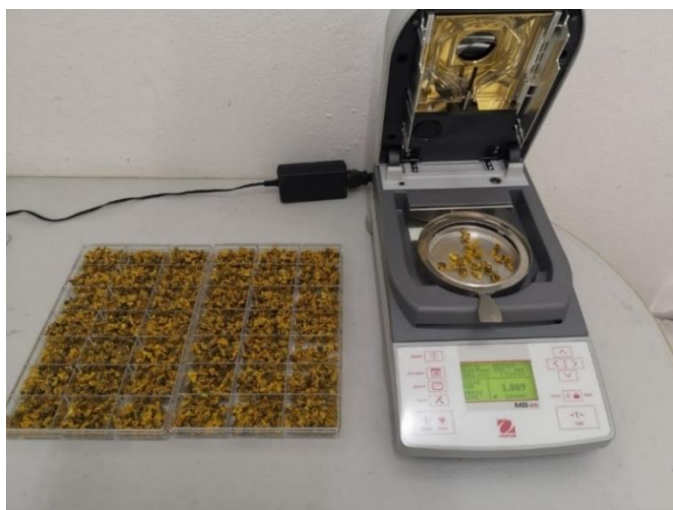
ภาพ 3.4 การตรวจวัดความชื้นสุดท้ายด้วยเครื่องวัดค่าความชื้นด้วยระบบหลอดฮาโลเจนของดอกเก๊กฮวยอบแห้ง
