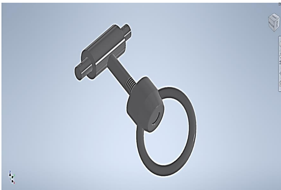
ภาพที่ ข.5 แบบร่างทางวิศวกรรมกายภาพของตัวล้อระหว่างฟากับหัวถัง แบบ 3D
