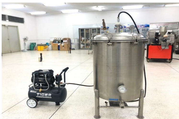
ภาพ 3.10 เครื่องแปรรูปไข่เค็มด้วยการใช้แรงดันไฮโดรสแตติกต้นแบบ
